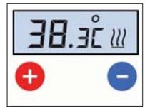
Stellen Sie nun den gewünschten Sollwert ein, z.B. 38,3 °C. Die rote LED blinkt, wenn die Solltemperatur um mehr als 1 °C über- oder unterschritten wird. Im Beispielfall bei unter 37,3 °C und über 39,3 °C.
